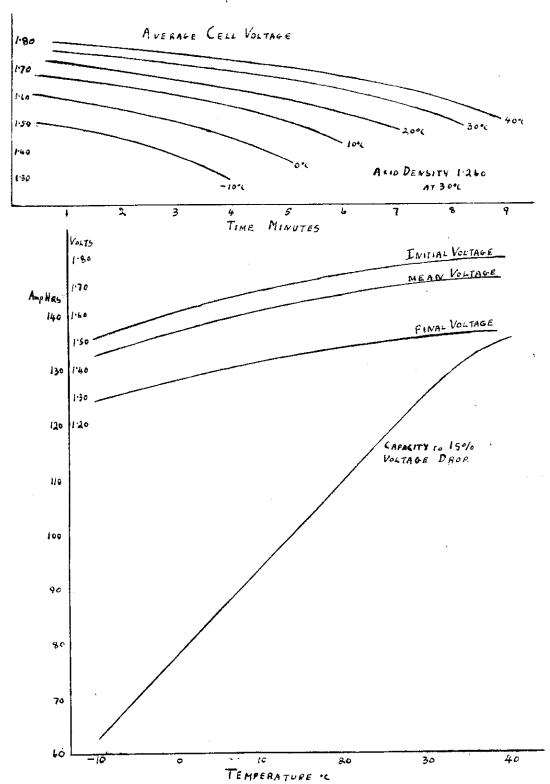
EFFECTOF RATE OF DISCHARGE ON CAPACITY AND VOLTAGE
