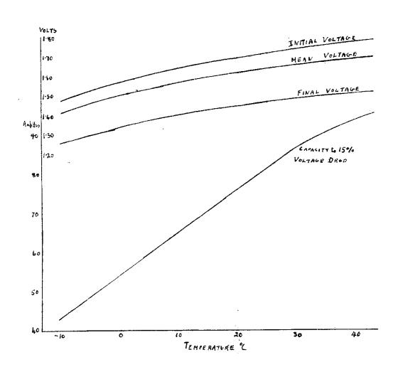
Nr. A. 4349c 3. DISCHARGE OF T. CELLS INITIAL TEMPERATURE 30°C.
