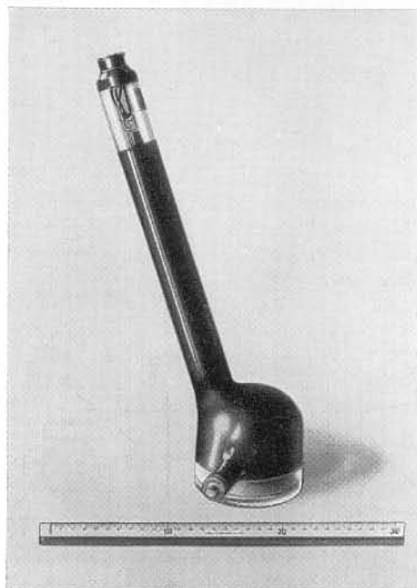
Abb. 11: Projektionsröhre für Heimempfänger 20 kV, 10 cm Schirmdurchmesser mit schrägem Strahleinfall.
