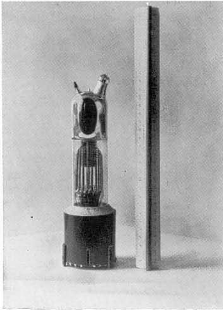
Abb. 7: 17gittige kleine Stabfotозelle.
