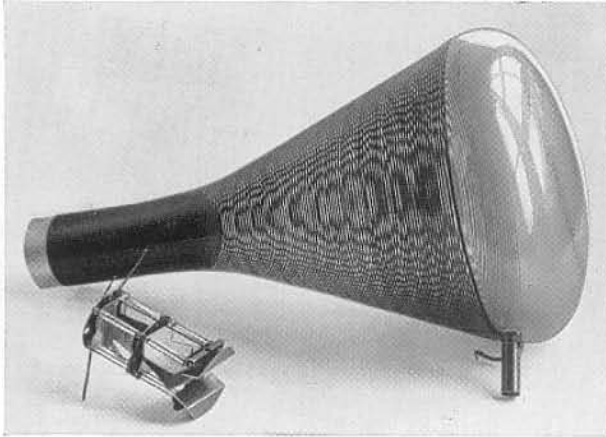
Abb. 3: Nachbeschleunigte Röhre von 1935.
