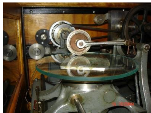
Abb. 7: Integrationsmechanismus des Differential Analyzer schematisch und fotografisch
