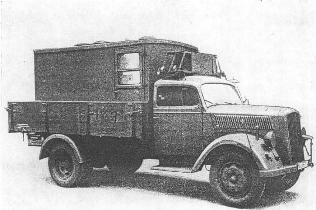
Seitenansicht des Pritschen-Kw. mit Kühlaufbau.
