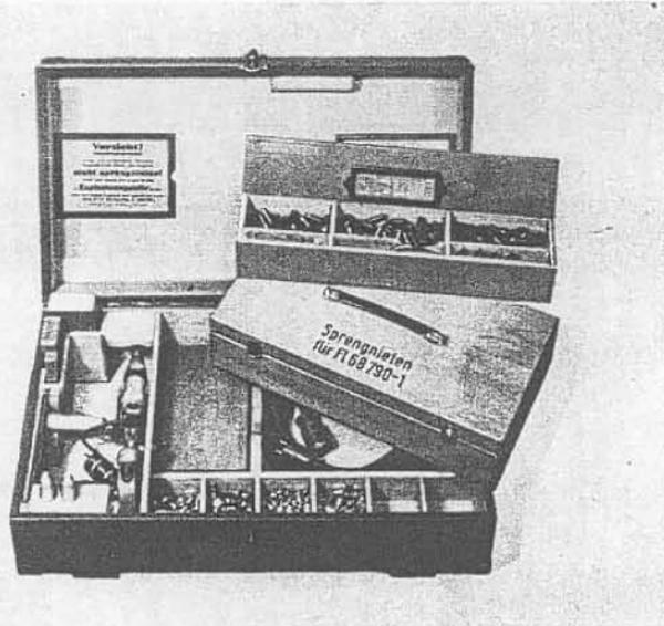
**Verwendungszweck:** Ausführung von behelfsmäßigen Reparaturen und Beseitigung von Beschußschäden an Flugzeugen durch Sprengnietverfahren.
