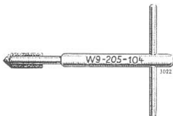
Abb. 39 Reiniger (Leder- wischer) für Düsenkörper
