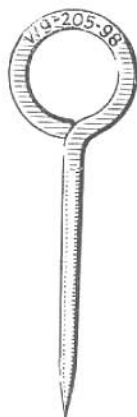
Abb. 38 Reiniger für Düsennadel und Düsenschneide
