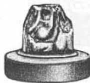
Abb. 13 Durch schlechten Kontakt abgeschmolzener Polbolzen
