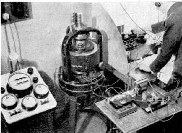
Die Frankesche Maschine als Tonfrequenz-Mess-generator im Labor. [6]
