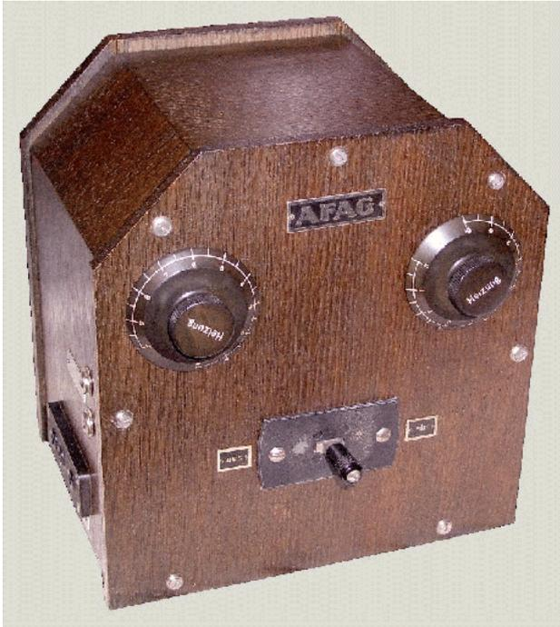
Bild 3: AFAG-Zweiröhren-Niederfrequenzverstärker Typ VN 2
