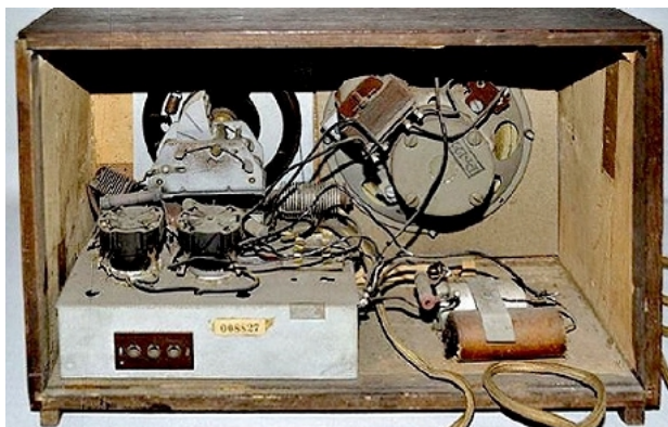
Bild 41: AT 217 GWK in 3. Serie aus einem Ebay-Angebot von 2011. Der Heizwiderstand fehlt und der hintere Elko ist gewechselt, aber ansonsten scheint das Gerät sehr original zu sein.
