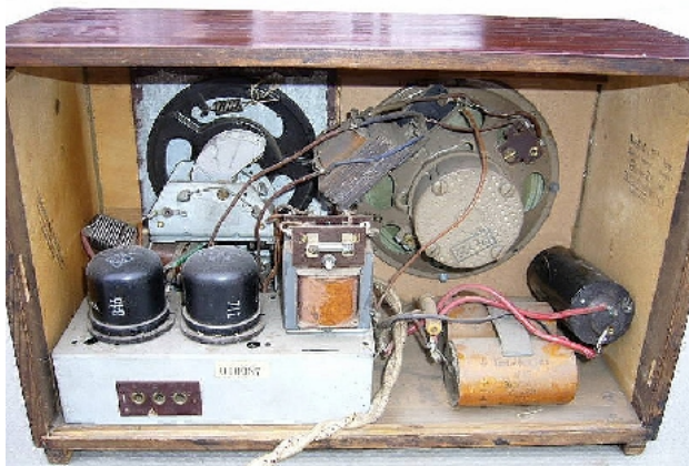
Bild 43: Einblick in das Innere des AT 218 Wke, das sehr original erscheint. Man muss sich nur den zusätzlichen schwarzen Elko rechts wegdenken.
