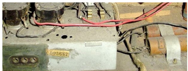
Bild 29: Originale Elko-Anordnung neben dem Chassis (aus einem Ebay-Angebot von 2012)
