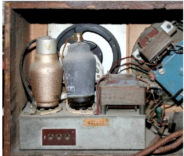
Bild 40: Sind andere CF 7 (auch NF 2) im Apparat, könnten dies Nachbestückungen sein.
