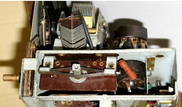
Bild 32: Rastfedern des Drehschalters
