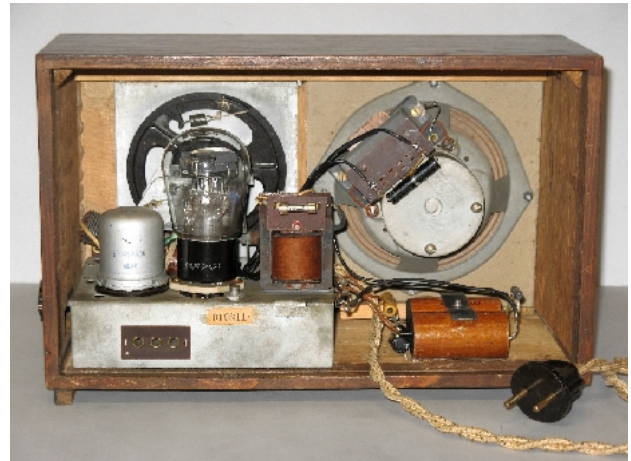
Bild 47: AT 218 Wke mit Endröhre RES 164
