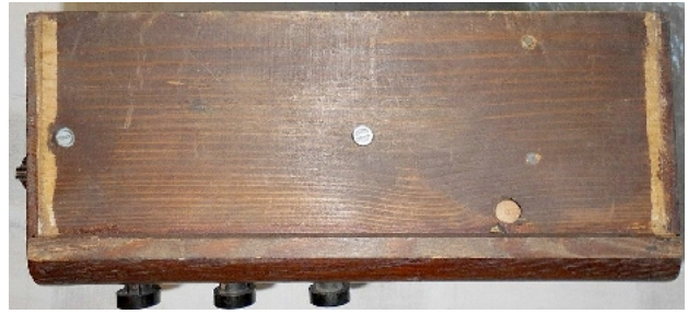
Bild 34: Ansicht des Gehäusebodens mit ungeschützten Befestigungsschrauben
