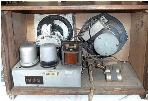
Bild 46: AT 218 Wke mit Glas-„Stahl“-Röhren aus dem Röhrenwerk Erfurt
