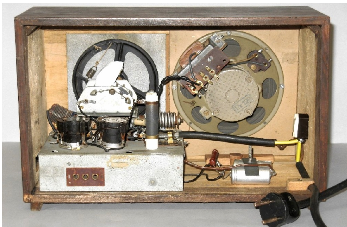
Bild 53: Elkos und Heizvorwiderstand sind erneuert, ein Netzschalter ist zusätzlich eingebaut
