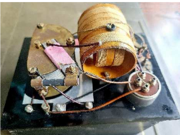
Bild 19: Gut sichtbar die Rückkopplungsspule.
