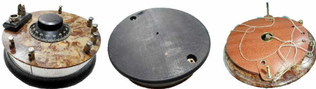
Bild 4: Luxus-Version "imitiert Büffelhorn", in der Mitte Bodenplatte von unten, rechts die gekapselte Spule.
