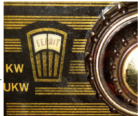
Bild 27: Sichtfenster für die Stellung der Ferritantenne.
