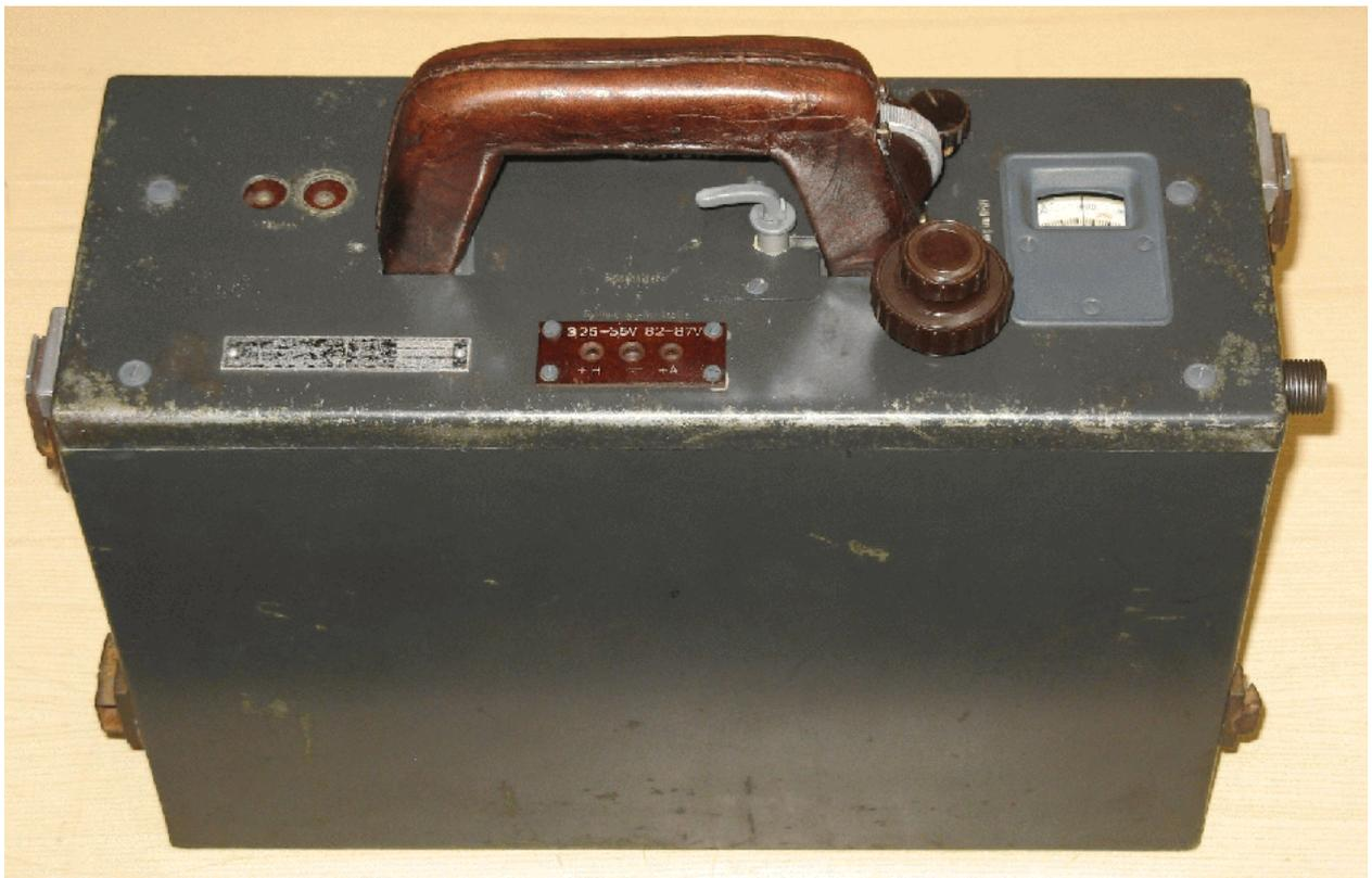
Ob die Rahmenantenne infolge der vollständigen Kapselung noch funktionstüchtig ist, darf bezweifelt werden. Im "Messgeräte-Kennblatt" [15.1] wird lediglich erwähnt: "... dient zum Aufsuchen von Störquellen ... an Störspannungsträgern (Lichtleitungen, Telefonleitungen und sonstigen elektrischen Anlagen)".
