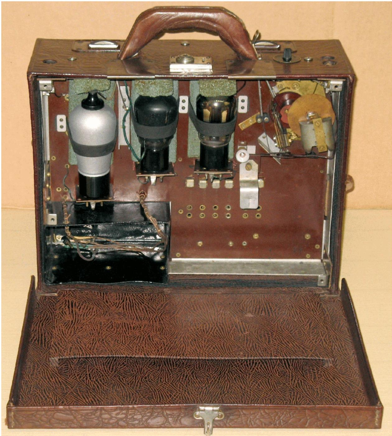
Nach dem Entfernen der Zwischenwand werden die auswechselbaren Elemente sichtbar, die Röhren und die Batterien. Die Röhrenbestückung ist wiederum RES 044, RE 084 und RE 134. Ungewöhnlich ist die Halterung der Röhren mit Gummibändern auf je einem Schaumstofflager sowie die Röhrenanschlüsse mit fliegenden Fassungen. Als Abschirmung trägt die RE 084 eine Bleikappe, die gleichzeitig die Klingeneigung verringert.
