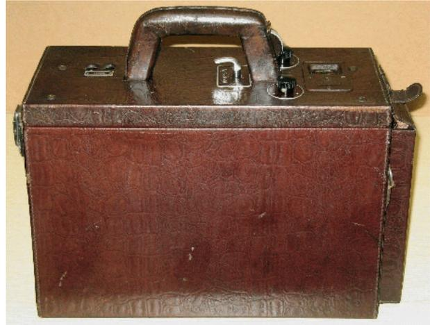
Der ab Anfang 1936 ausgelieferte Störsuchgeräte-Typ SuG 68 ist im Grunde genommen lediglich eine Umbenennung des bewährten Typs SuG 33 m. Der einzig erkennbare Unterschied ist der Fortfall der Frontklappe. Sollte der Kopfhörer in dem dafür vorgesehenen Fach untergebracht werden, müsste vor und nach
