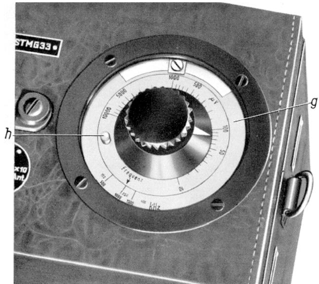
Der bei der Verstärkungseichung eingehende Unterschied einzelner Suchgeräte wird im Werk durch Verdrehung der äußeren Skalenscheibe "g" und darauf folgende Festlegung beseitigt. Dem Frequenzgang wird Rechnung getragen durch Marken mit Frequenzbezeichnung auf dieser Skala, die den Frequenzbezeichnungen der Suchgeräteskala entsprechen. Bei der Messung wird die Skala "h" so verdreht, dass der Pfeil auf die entsprechende Messfrequenz zu stehen kommt. [11.1]
