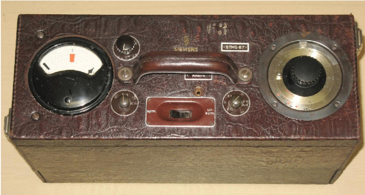
Als Detektor für die Geräuschspannungen wird eine Batterietriode RE 034 verwendet. Die zum Betrieb erforderlichen Batterien sind dieselben wie im Störsuchgerät, eine 4,5-Volt-Heizbatterie Typ 116 sowie eine 90-Volt-Anodenbatterie Rfb 24 [13.1].
