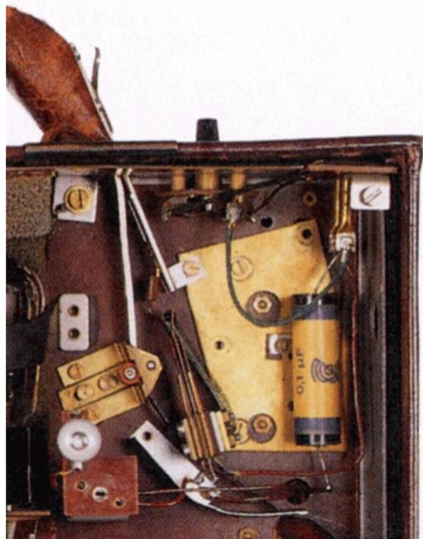
Bislang lag der Kopfhörer direkt im Anodenzweig der Endröhre, was bedeutet, dass eine der Kopfhörerbuchsen mit dem Pluspol der Anodenbatterie verdrahtet war. Sollte dieser Anschluss mit einem masseführenden Teil in Verbindung geraten, würde die Anodenbatterie kurzgeschlossen. Die Sicherungslampe sollte dies mit ihrem Durchbrennen verhindern.
