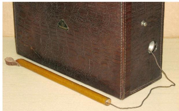
Als Zuleitung der Tastantenne ist eine Gummischnur mit Innenleiter vorgesehen, die im Ruhezustand im Geräteinneren zwischen Rollen aufgespannt ist und bei Bedarf bis zu 80 cm weit aus dem Suchgerät herausgedehnt werden kann. Leider verlor das Gummi der Schnur bald an Zugkraft, so dass sie heute schlaff hängt und dadurch das Einschleiben der Tastantenne in ihren Köcher behindert. Das komplette Einschleiben ist
