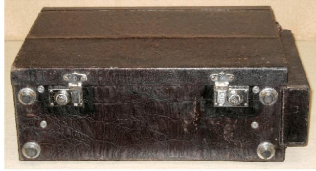
Die plombierbare Zwischenwand des Rfss 21 konnte entfallen, weil die Bedienung jetzt nicht mehr Funkfreunden der Funkhilfe, sondern geschultem Post-Personal oblag. Das Gehäuse ist als viereckiger Trog ausgebildet, aus dem das Chassis samt Deckplatte nach oben herausgehoben werden kann.
